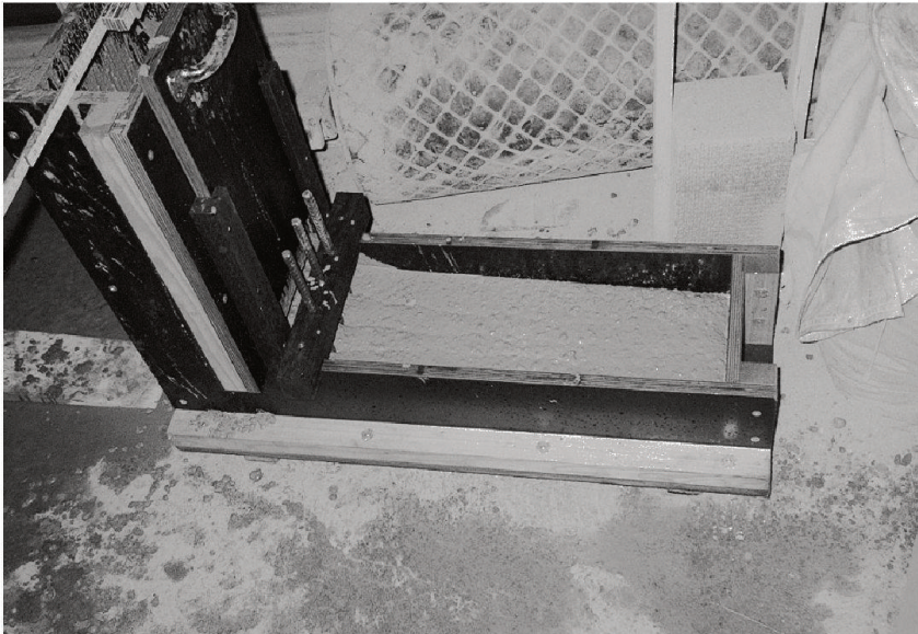
Abb. 2 Konsistenzbestimmung mit der schwedischen L-Box; der Abstand zwischen den Bewehrungsstäben beträgt hier 34 mm. Bei einem SCC füllt sich der liegende Teil innerhalb weniger Sekunden; die Oberfläche ist annähernd horizontal.
