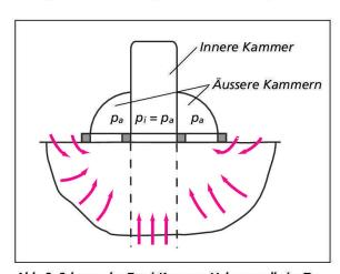
Abb. 3 Schema der Zwei-Kammer-Vakuumzelle im Torrent-Gerät (nach [9]).
