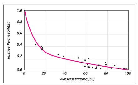
Abb. 4 Einfluss der Wassersättigung auf die relative Gaspermeabilität von Normalbetonen (W/Z = 0.45) nach [6].
