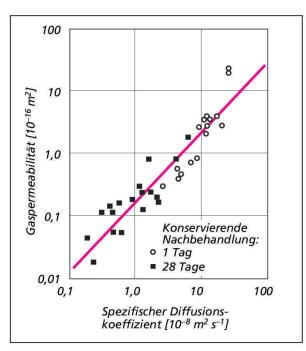
Abb. 6 Beziehung zwischen der Gaspermeabilität und dem spezifischen Diffusionskoeffizienten für Betone [3].
