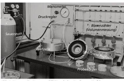
Abb. 1 Messung der Gaspermeabilität nach dem Cembureau-Verfahren.
