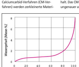
Abb. 3 Typische Sorptionsisotherme von Beton [2].
