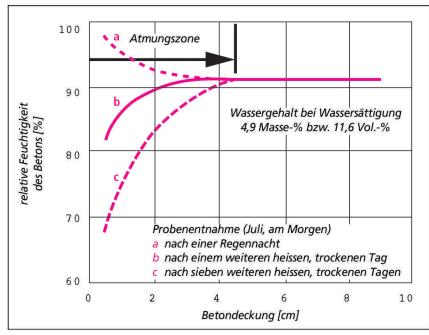
Abb. 2 Einfluss der Umgebung auf den Wassergehalt einer Mole in Helgoland (ermittelt an Bohrkernen), nach [5].
