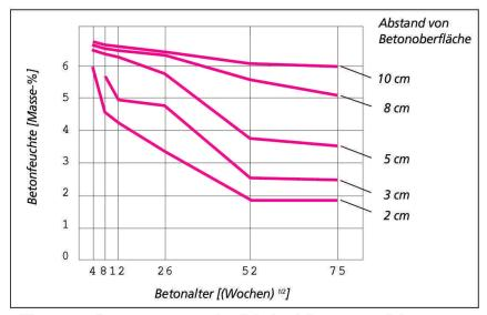
Abb. 4 Austrocknen einer unten und seitlich abgedichteten 20 cm dicken Betonplatte (B 25) bei 50–60 % RF und 20  $^{\circ}$ C [7].
