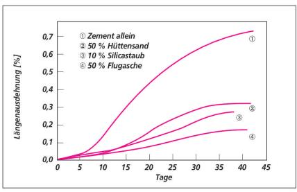
Abb. 4 Längenausdehnung von Betonprismen (75 x 75 x 300 mm), die AAR-reaktive Zuschläge enthalten, in denen Zement (1 Massen-% Na<sub>2</sub>O-Äq.) teilweise durch Hüttensand, Silicastaub bzw. Flugasche ersetzt wurde (nach [2]).
