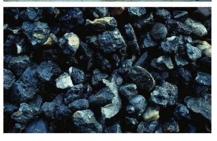
cling-Granulat ersetzt. Dabei werden für die Herstellung und den Einbau die gleichen Geräte wie für herkömmliche Strassenbetone eingesetzt. Die Verwendung von Recycling-Granulat erfordert allerdings mehr Erfahrung und Sorgfalt als diejenige von «neuen» Zuschlägen.
