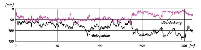
Abb. 9 Brückenuntersuchung: Datensatz (oben) sowie Belagsdicke und Bewehrungsüberdeckung (unten).
