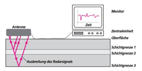
Abb. 8 Schematische Darstellung des Funktionsprinzips von Impulsradar-Messungen (nach [12]).
