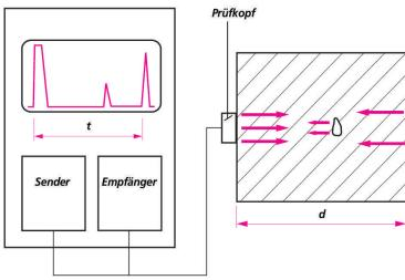
Abb. 6 Schematische Darstellung einer Ultraschall-Impuls-Echo-Messung (nach [9]).
