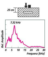
Abb. 5 Frequenzspektren für eine 0,50 m dicke Betonplatte (links) sowie für eine 0,50 m dicke Betonplatte, die in 0,25 m Tiefe einen Hohlraum aufweist (nach [8]).
