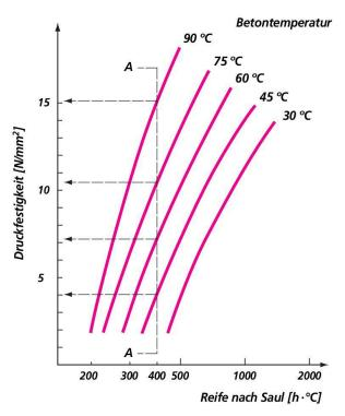
Abb. 1 Nach Saul [1] müssten die Druckfestigkeiten der gleich zusammengesetzten, aber bei unterschiedlichen Temperaturen erhärteten Betone bei gleicher Reife gleiche Druckfestigkeiten aufweisen (z.B. bei 400 h·°C, d.h. bei Schnitt A–A) [2, 5].
