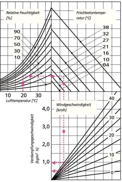
Abb. 1 Abschätzung der Einflüsse der Frischbeton- und Lufttemperatur, der relativen Feuchtigkeit sowie der Windgeschwindigkeit auf den Feuchtigkeitsverlust an der ungeschützten Betonoberfläche. Im angegebenen Beispiel (20 °C warmer Beton, relative Feuchtigkeit 50 %, 20 °C Lufttemperatur, Windgeschwindigkeit 20 km/h) beträgt der stündliche Wasserverlust 0,5 kg/m². Quelle: [2], modifiziert.
