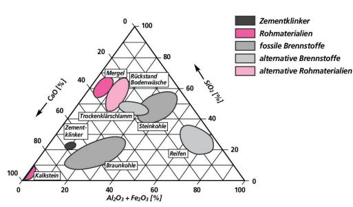
Abb. 1 Rankine-Diagramm von Zementklinker sowie primären und sekundären (alternativen) Ausgangsstoffen bei der Zementklinkerherstellung [1].
