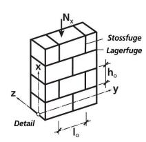
Einsteinmauerwerk mit Beanspruchungen und Koordinatensystem;  $N_x$  = Normalkraft,  $M_z$  = Biegemoment um die z-Achse,  $h_o$  = Schichthöhe (Höhe des Steins plus eine Lagerfuge,  $I_o$  = Steinlänge plus eine Stossfuge (nach [1]). zeichnung: TFB
