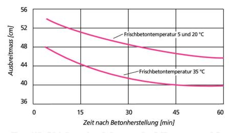
Abb. 5 Abhängigkeit der Konsistenzänderung von der Frischbetontemperatur bei konstanter Betonzusammensetzung (300 kg CEM I/m³, W/Z-Wert 0,50) [5]. Grafik: TFB
