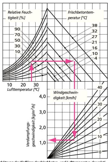
Abb. 6 Abschätzung der Einflüsse der Frischbeton- und Lufttemperatur, der relativen Luftfeuchtigkeit sowie der Windgeschwindigkeit auf den Feuchtigkeitsverlust an der ungeschützten Betonoberfläche. Im angegebenen Beispiel verliert ein 30 °C warmer Beton bei 27 °C Lufttemperatur und 50 % relativer Feuchtigkeit bei einer Windgeschwindigkeit von rund 20 km/h stündlich rund 1,25 kg Wasser pro Quadratmeter. Quelle: [8], mod.
