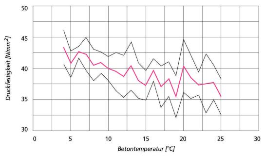
Abb. 4 Einfluss der Temperatur auf die 28-Tage-Druckfestigkeit (Mittelwert und Standardabweichungen). Quelle: Kies und Beton AG, Maienfeld; Auswertung: TFB.
