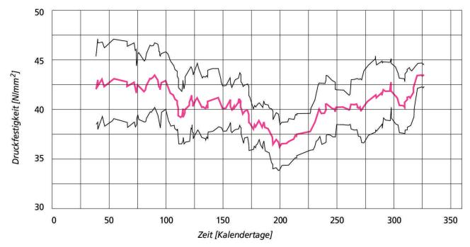
Abb. 1 Jahresgang der 28-Tage-Druckfestigkeit (Mittelwert und Standardabweichungen s) von Beton B 35/25 aus fünf Schweizer Betonwerken (1993–1995). Quelle: Kies und Beton AG, Maienfeld; Auswertung: TFB.
