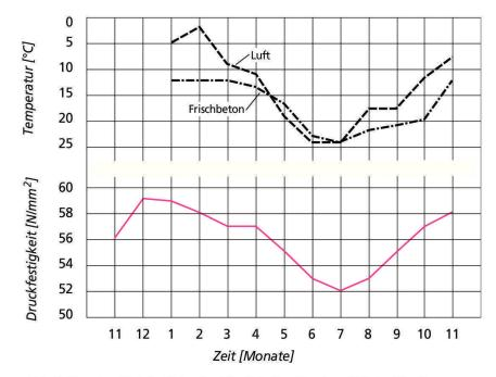
Abb. 2 Monatsmittel der Betondruckfestigkeiten für einen Teil des Oberbaus der Aichtalbrücke in Deutschland sowie Luft- und Frischbetontemperaturen (nach [2], mod.).
