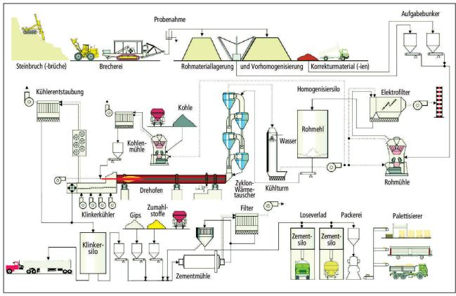
Abb. 1 Herstellung von Portlandzement.
