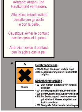
Abb. 8 Warnhinweise auf Zementsäcken: (a) in der Schweiz; (b) in Deutschland. Informationen zum Umgang mit Zement können auch den Sicherheitsdatenblättern entnommen werden, die bei allen Zementwerken erhältlich sind. Grafik: TFB
