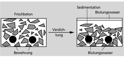
Abb. 1 Nicht alles Blutungswasser gelangt an die Bauteiloberfläche.
