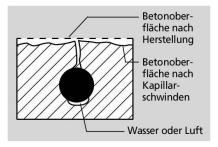
Abb. 2 Rissbildung über einem Bewehrungsstab als Folge von Bluten und Kapillarschwinden.
