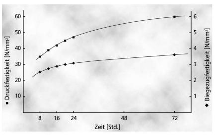
Abb. 1 Entwicklung der Biegezug- und der Druckfestigkeit von frühfestem Reparaturbeton.
