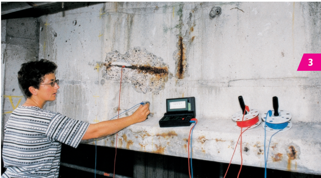
Potentialmessung an Brückenunterseite.
