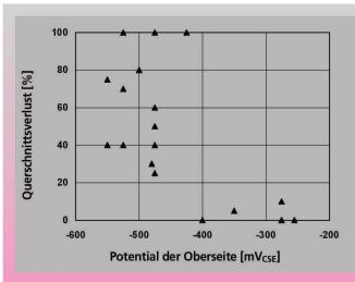
Abb. 3 Zusammenhang zwischen Querschnittsverlust der Bewehrung und Potential [4].
