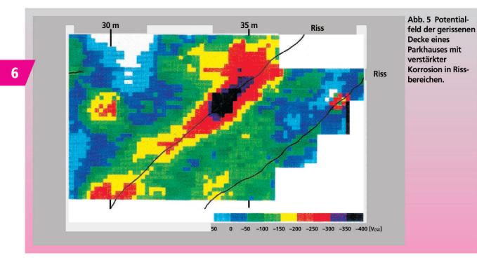
effizienten von etwa 1 mV/°C. Grundsätzlich muss zwischen Potentialpunkt- und Potentialfeldmessungen unterschieden werden. Potentialpunktmessungen sind Messungen mit Einzelelektroden. Der übliche Messraster beträgt 0,5 x 0,5 bis 1,0 x 2,0 m, woraus 0,1 bis 25 Messpunkte/m² resultieren. Potentialfeldmessungen werden mit Mehrelektrodensystemen durchgeführt. Der engmaschige Messraster (0,15 x 0,15 bis 0,50 x 0,50 m) liefert entsprechend viele Messpunkte (4 bis
