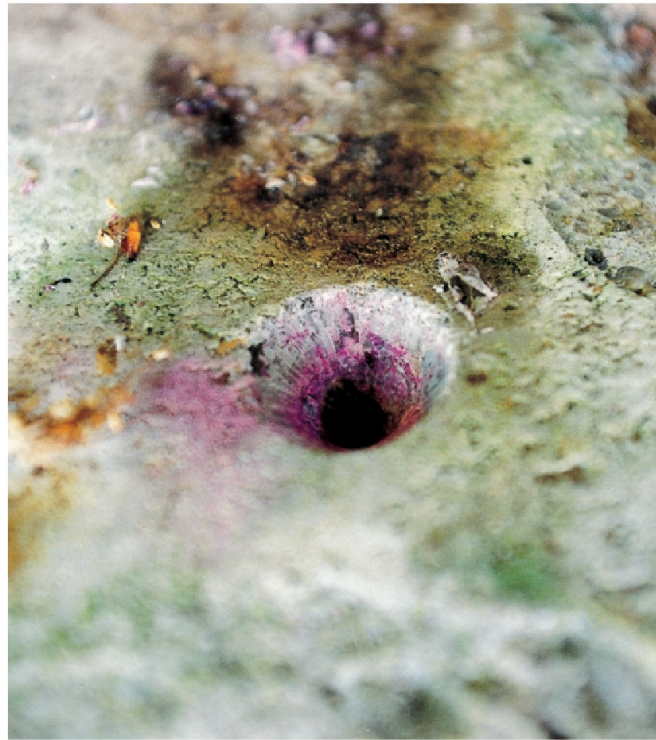
Einfache Bestimmung der Karbonatierungstiefe (Phenolphthaleintest).
