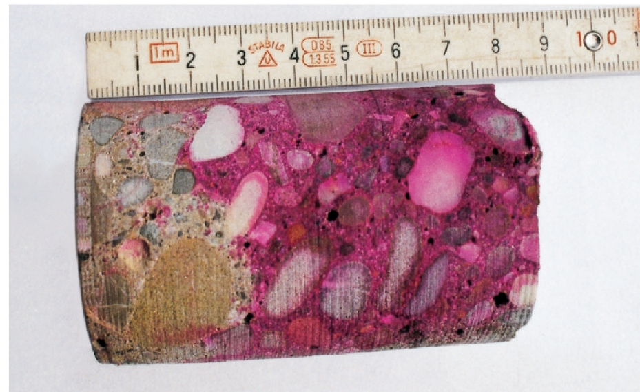
Nachweis der Karbonatisierungstiefe mit Phenolphthalein an Bohrkern.
