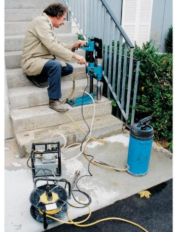
Bohrkernentnahme als Teil einer zerstörenden Untersuchung.
