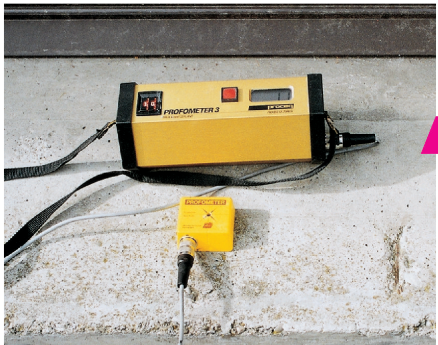
Messung der Überdeckung eines korrosionsgeschädigten Fenstersimses.
