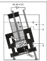
Abb. 1 Messzelle zur Bestimmung des Chloridwiderstands von Beton (a: 3 % NaCl in 0,2 m KOH; b: 0,2 m KOH; c: Mörtelprobe, h = 50 mm,  $\emptyset = 50$  mm; d: Chlorideindringfront).
