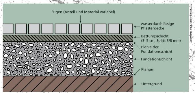
Abb. 1 Aufbau einer wasserdurchlässigen Pflasterdecke nach [11].
