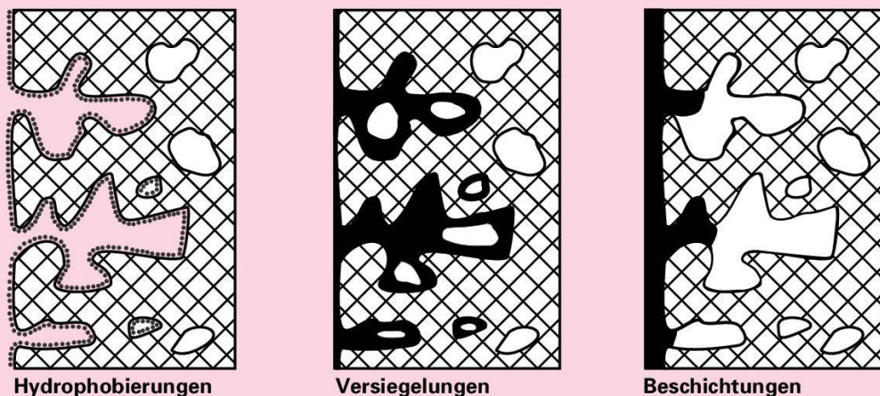
Abb. 1. Schematische Darstellung von Hydrophobierungen, Versiegelungen und Beschichtungen (nach [7]).
