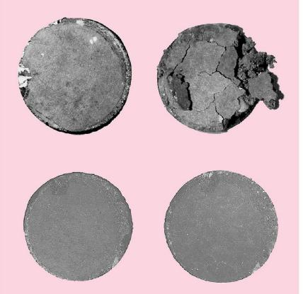
Betonproben aus einem Fluchtbalkon vor und nach der Frosttausalzbeständigkeitsprüfung (100 Zyklen): oben unbehandelte Proben, unten nach dem im Kasten «Ein Schweizer Versiegelungssystem» beschriebenen Verfahren imprägnierte Proben. Fotos: Rascor AG, Oberweningen
