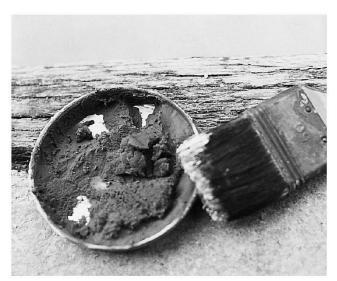
Abb. 3 Aus Trichlorethan und Bentonit wird eine Paste hergestellt.
