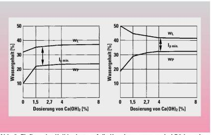
Abb. 2 Einfluss des Kalkhydrats auf die Konsistenzgrenzen bei Böden mit kleiner bis mittlerer Plastizität (links) und bei Böden mit grösserer Plastizität (rechts) (nach [2]).
