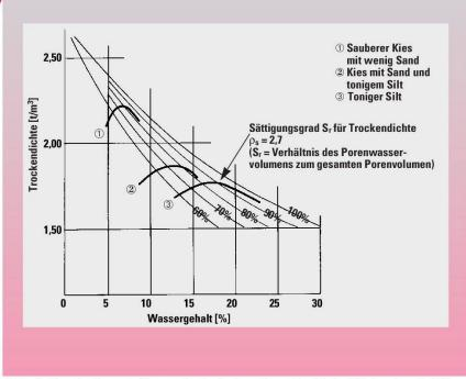
Abb. 1 Proctorkurven für geotechnisch unterschiedliche Böden (nach [9]).
