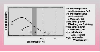
Abb. 4 Bestimmung der Weissfeinkalkdosierung für die Sofortreaktion im Bereich wopt bis (wopt + ca. 2 %) nach [2].
