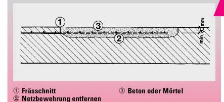
Abb. 3 Reparatur von Oberflächenschäden [5].
