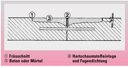
Abb. 2 Reparatur von Kantenschäden [5].
