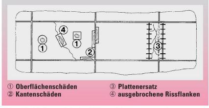
Abb. 1 Die häufigsten Schadensbilder und Reparaturmassnahmen bei Betonbelägen [5].
