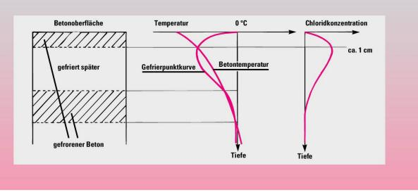
Abb. 1 Schichtweise gefrierendes Wasser in FT-beanspruchtem Beton kann zu Abplatzungen führen [4] (siehe Text).
