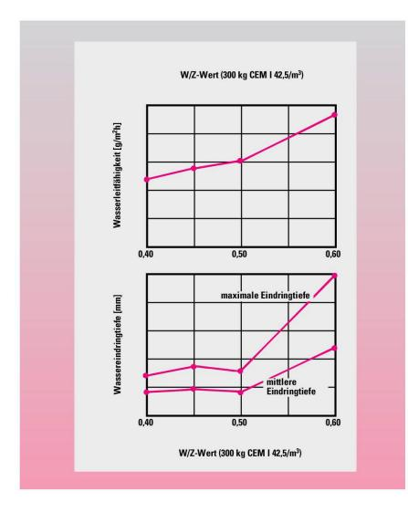
Abb. 5 Gegenüberstellung der Resultate einer Wasserleitfähigkeitsprüfung gemäss Norm SIA 162/1, Prüfung Nr. 5, (oben) mit den Resultaten einer Wasserundurchlässigkeitsprüfung nach ISO 7031 (Einzelmessungen; unveröffentlichte Resultate der TFB).
