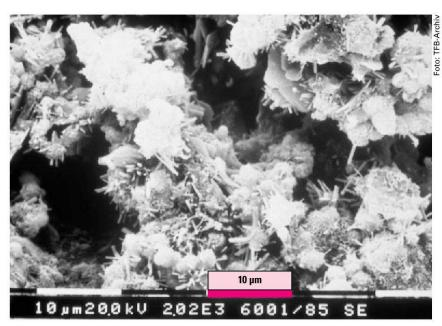
Abb. 2 Das Zementgel besteht aus verfilzten stengeligen und gröberen Hydratationsprodukten.
