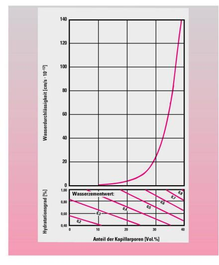
Abb. 3 Zusammenhang zwischen Kapillarporosität und Wasserdurch-
