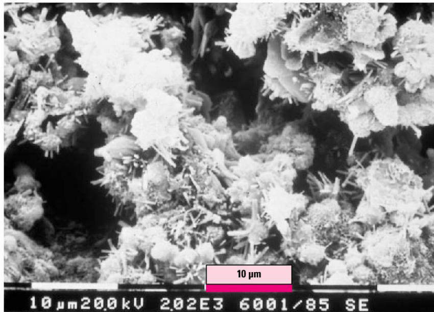
Abb. 2 Das Zementgel besteht aus verfilzten stengeligen und größeren Hydratationsprodukten.
