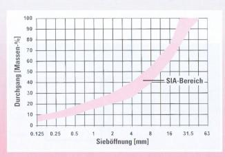
Abb. 5 Wenn die Siebkurve für natürliches gerundetes Material nicht durch Vorversuche festgelegt wird, muss sie nach Norm SIA 162 im schraffierten Bereich («SIA-Bereich») liegen.
