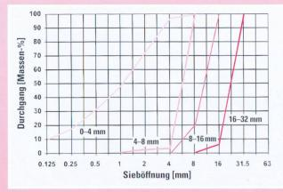
Abb. 6 Sieblinien der Einzelkomponenten.
