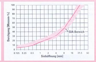
Abb. 7 Sieblinie des aus vier Körnungen zusammengesetzten Zuschlagstoffes.
