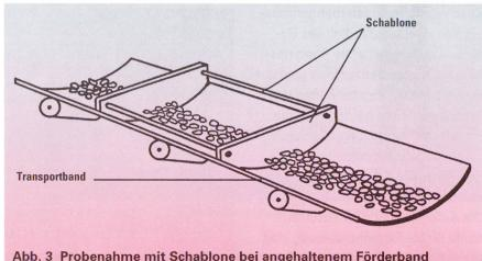
Abb. 3 Probenahme mit Schablone bei angehaltenem Förderband (Zeichnung: Norm SN 670 800 c [4]).
