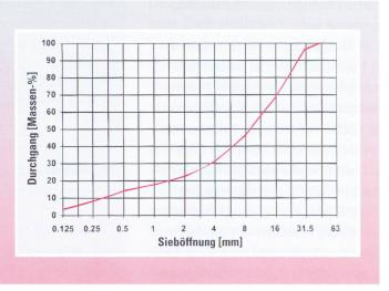
Siebanalyse zu tun haben [3–7]. Für Siebanalysen werden – der Name besagt es – Siebe mit definierten Öffnungen (Loch- oder Maschenweiten) verwendet. Die üblichen
