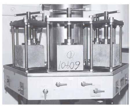
Versuchseinrichtung der TFB für Wasserundurchlässigkeitsprüfungen.
