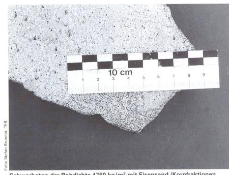
Schwerbeton der Rohdichte 4760 kg/m³ mit Eisensand (Kornfraktionen 0,1-0,2 mm, 0,3-0,6 mm und 0,5-1,0 mm) als Schwerzuschlag.
