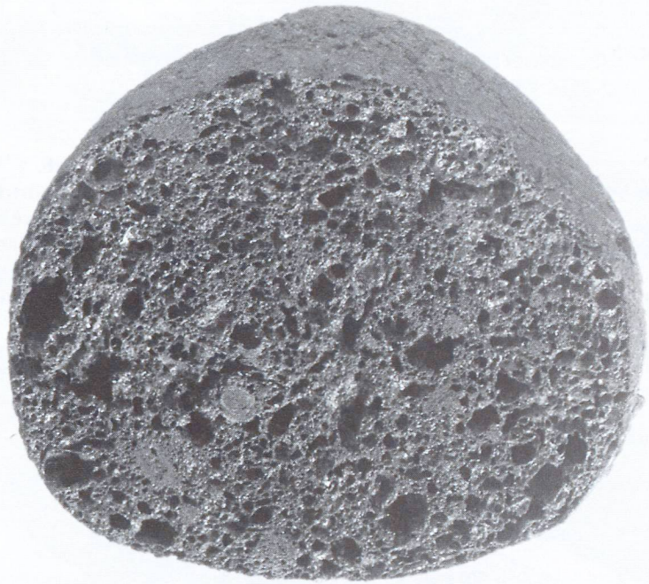
Schnitt durch ein Blähtonkorn (Durchmesser ca. 20 mm).
