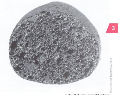
Schnitt durch ein Blähtonkorn (Durchmesser ca. 20 mm).
