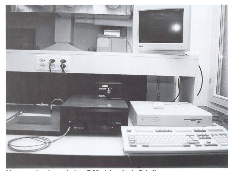
Messung des dynamischen E-Moduls mittels Schallresonanz.
