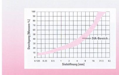
Abb. 2 Wenn die Siebkurve für natürliches gerundetes Material nicht durch Vorversuche festgelegt wird, muss sie nach Norm SIA 162 [2] im schraffierten Bereich («SIA-Bereich») liegen.
