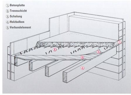
Schema 1 Holz-Beton-Verbundtragwerk in Neubau.
