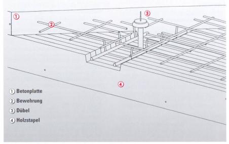
Schema 3 Aufbau eines Holz-Beton-Verbundsystems
