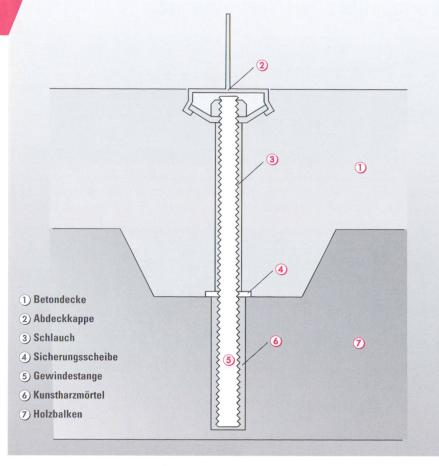
Schema 4 Aufbau eines montierten Injektionsdübels (nach [16, 17]).
