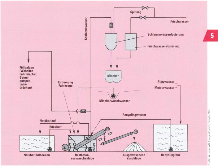
Abb. 2 Wasserflussschema einer Restbetonauswaschanlage. Alles anfallende Recyclingmaterial wird in Feststoffe und Schlammwasser getrennt und wiederverwendet.
