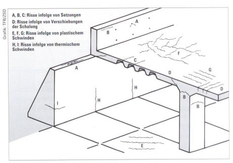
Abb. 2 Schematische Darstellung von Rissen, die in jungem Beton entstehen können (nach [11] und [12], modifiziert).
