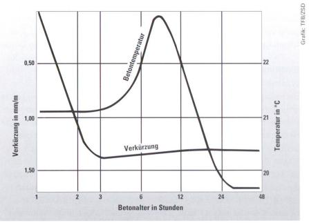
Abb. 5 Chemisches Schwinden eines Betonzylinders (350 kg Portlandzement, W/Z = 0.55, 20 °C); Feuchtigkeitsabgabe an Umgebung unterbunden (nach [2]).
