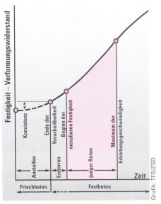
Abb.1 Reaktionsphasen eines Frischbetons mit ursprünglich weicher Konsistenz (Schema) nach [3].
