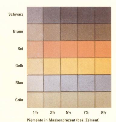
Abb. 1 Mit zunehmender Pigmentkonzentration nimmt die Farbintensität eines Betons zu, bis die sogenannte Sättigungskonzentration erreicht ist.
