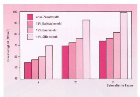
Abb. 1 Druckfestigkeitsentwicklung von zusatzstoffhaltigen Betonen nach [6] (siehe Text).
