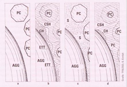
Abb. 2 Schematische Darstellung der Bildung von Übergangszonen in Betonen ohne (2a und 2b) und mit Silicastaub (2c und 2d) nach [10] (siehe Text). Abkürzungen: AGG=Zuschlag, PC=Portlandzementklinkerteilchen, S=Silicastaubteilchen, CH=Ca(OH)<sub>2</sub>, CSH=Calciumsilikathydrat, ETT=Ettringit.
