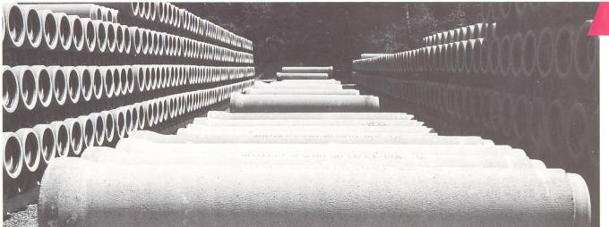
Betonrohre aus flugaschehaltigem Beton.
