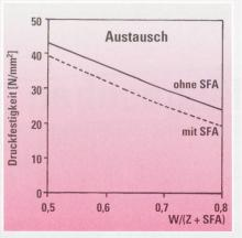
Abb. 1 Abhängigkeit der Druckfestigkeit von der Art der Flugaschenzugabe (SFA = Steinkohlenflugasche) [9].
