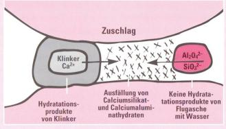
Abb. 3b Schematische Darstellung der Reaktion von Flugasche in Anwesenheit von hydratisiertem Portlandzementklinker (nach [9]). Grafik: TFB/ZSD, S, Einfalt
