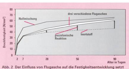
Abb. 2 Der Einfluss von Flugasche auf die Festigkeitsentwicklung setzt erst verspätet ein (nach [13]).
