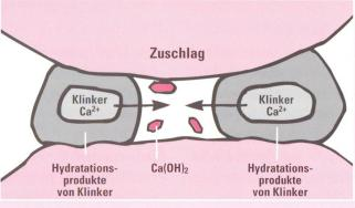
Abb. 3a Hydratation von Portlandzementklinker (nach [9]).
