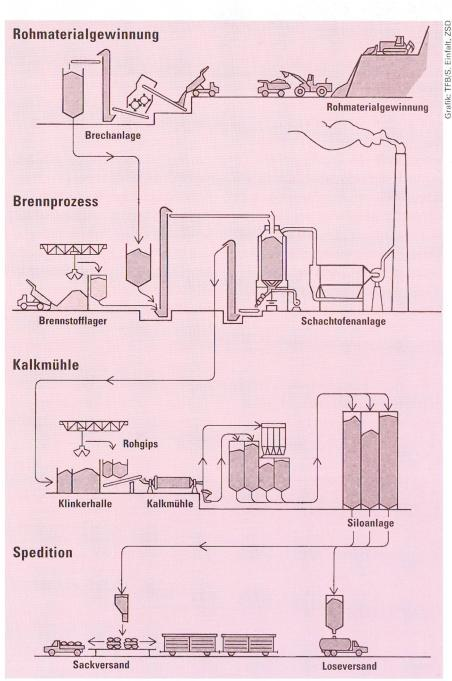
Abb. 1 Fabrikation von hydraulischem Kalk ([6], modifiziert).
