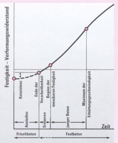
phase dauert bis zum Zeitpunkt, in dem der Beton eine gerade noch messbare Festigkeit (etwa 0,1 N/mm²) aufweist. Es folgt die Erhärtung des Betons, die mit der Phase des jungen Betons beginnt. Die Phase des jungen Betons reicht vom Erstarrungsende bis zum Zeitpunkt der grössten Erhärtungsgeschwindigkeit (Wendepunkt in der Erhärtungskurve).
