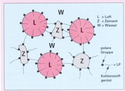
Abb. 1 Wechselwirkungen zwischen Zement, Luft, Wasser und LP-Molekülen [19].
