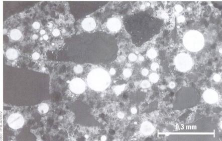
Durch Luftporenmittel lassen sich künstlich Luftporen (im Dünnschliff als weisse Fläche im Zementstein zwischen den Zuschlagkörnern erkennbar) in den Beton einführen. Dadurch wird der Beton frostund frosttausalzbeständiger.
