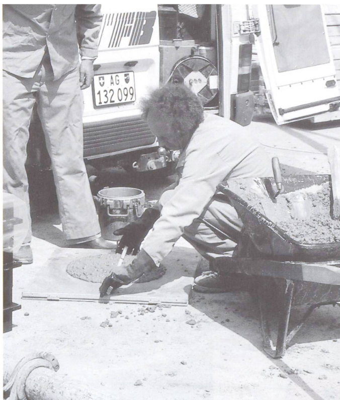
Die Frischbetonkontrolle ist ein wichtiger Baustein bei der Qualitätssicherung von zusatzmittelhaltigem Beton.
