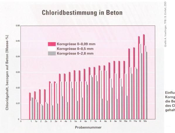
Einfluss der Korngrösse auf die Bestimmung des Chloridgehalts in Beton.
