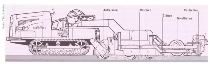
Schema 1. Selbstfahrende Recyclingmaschine um 1960, welche die Arbeitsgänge Aufreissen, Mischen, Glätten, Nivellieren und Verdichten ausführen konnte.
