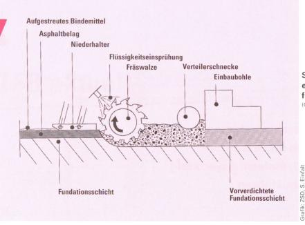
Schema 2. Arbeitsprinzip einer modernen Maschine für Kaltrecycling.
