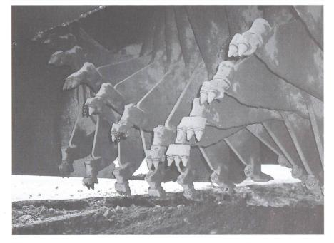
Zaugg SA, Bulle, wurde eine wesentlich kostengünstigere Variante gewählt: das Kaltrecycling. Dem Unternehmen stand dafür der Ra-Co 250 zur Verfügung, der von der Firma Rabaud in Saint-Soupplets (Frankreich) entwickelt worden ist. Die fast 18 t schwere, 8,90 m lange und 2,99 m breite Maschine ist mit einem 2,40 m breiten Rotor ausgerüstet, der sich mit maximal 180 Umdrehungen pro Minute entgegengesetzt zur Vorschubrichtung
