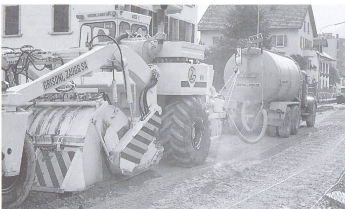
Kaltrecycling mit Ra-Co 250. Der über einen Schlauch an- geschlossene Tank liefert das eingesprüh- te Wasser.
