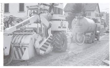
Kaltrecycling mit Ra-Co 250. Der über einen Schlauch angeschlossene Tank liefert das eingesprühte Wasser.
