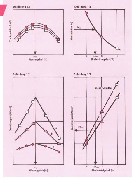
Zusammenhänge zwischen Trockendichte und Wassergehalt (Abbildung 1.1), Druckfestigkeit und Wassergehalt (Abbildung 1.2), Druckfestigkeit und Zementgehalt (Abbildung 1.3) sowie Masseverlust nach zwölf Frostauftauzyklen und Bindemittelgehalt (Abbildung 1.4) nach [1].
