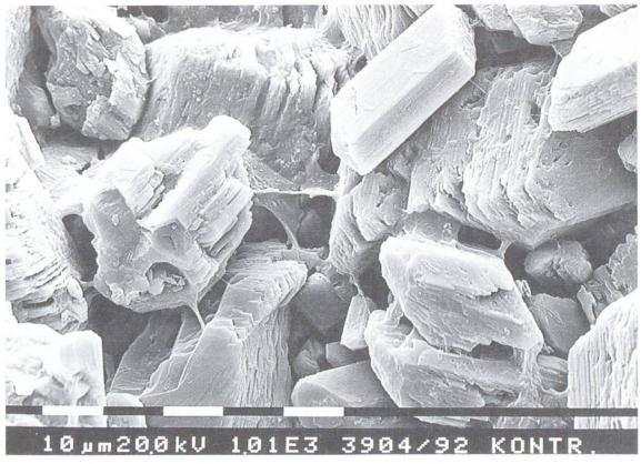
Korrodierter Zementstein mit Gipskristallen; Vergrösserung etwa 1000mal.
