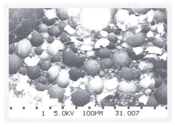
Aufnahme von Schaumbeton unter dem Rasterelektronenmikroskop.
