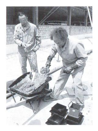
2 wird. Ihr kommt auch eine zentrale Rolle bei der Bestellung von Beton und bei der Beurteilung der Gebrauchstauglichkeit von Bauwerken aus Beton zu. Zudem wird mittels der Würfeldruckfestigkeit nachgewiesen, dass die auf die Beanspruchung des Tragwerks und die Möglichkeiten der Herstellung abgestimmte vorgeschriebene Festigkeit erreicht wird (Norm SIA 162/1 [2], Ziffer 3 01 11).
