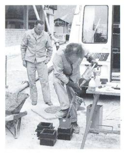
Verdichten des Betons mittels eines Vibrators.
