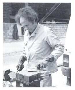
Abtaloschieren der Oberfläche des fertig hergestellten Würfels.
