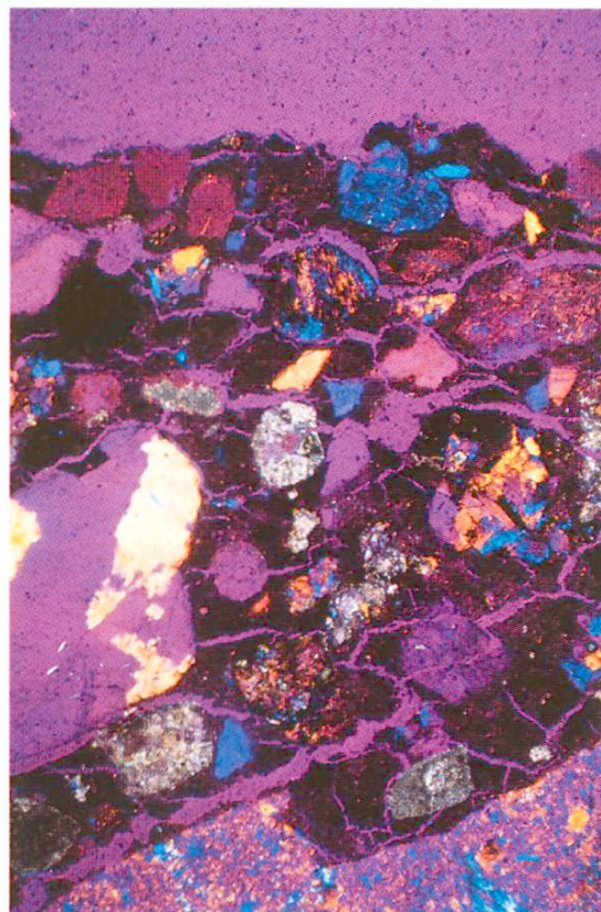
Mikroskopische Dünnschliffuntersuchungen einer brandgeschädigten Betonprobe: Hohe Temperaturen haben Risse im Zementstein, an der Verbundzone Zuschlag/Zementstein und im Zuschlag verursacht. (Bildausschnitt: 2,7×1,8 cm; links Fluoreszenzlicht, rechts polarisiertes Licht und \lambda -Plättchen.) (Foto: TFB, Vernier)
