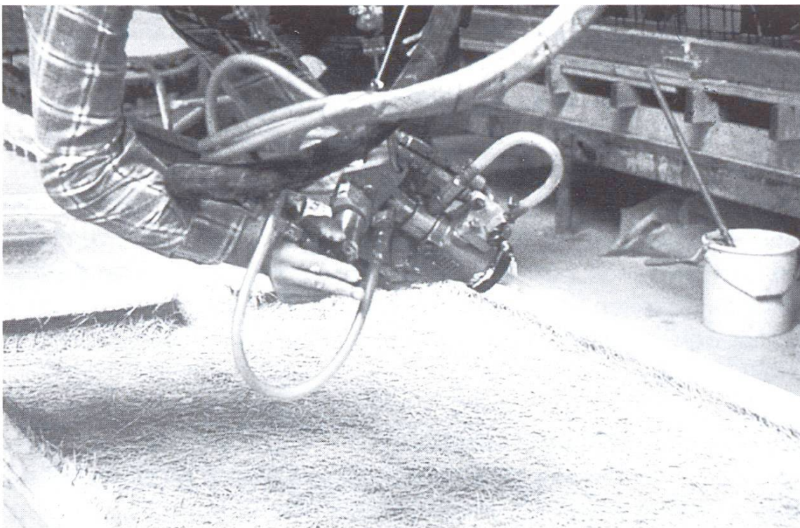
Verarbeitung von Glasfaserbeton nach dem Spritzverfahren.
